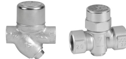
1. Purgador termodinámico con anillo bimetal incorporado, que evita bloqueos por aire.
