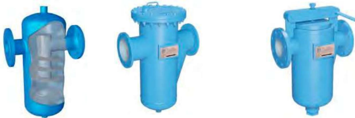
Filtro Tipo T, con Bridas o para Soldar, PN10, PN16, PN25, PN40 y 150lbs, 300lbs, 600lbs, 1500lbs, desde DN20 (3/4") hasta DN1000 (40"). Cuerpo en Acero al Carbono (ASTM A234 WPB) y en Acero Inoxidable (ASTM A 403 WP316). Tamiz en AISI-304 (para filtros en Acero Carbono) y AISI-316 (para filtros en Inoxidable). Los filtros han sido diseñados según con la norma DIN 3840 y B16.34. Fabricaciones bajo pedido.
